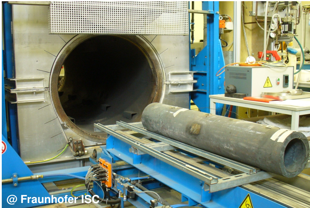
Sinterofen am ISC (Innenraum Ø 900 mm, Länge 2500 mm)
