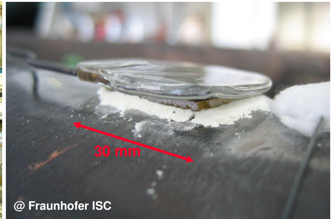
Klebeglas und zusätzliches Glaslotpulver auf dem emaillierten Stahlrohr
